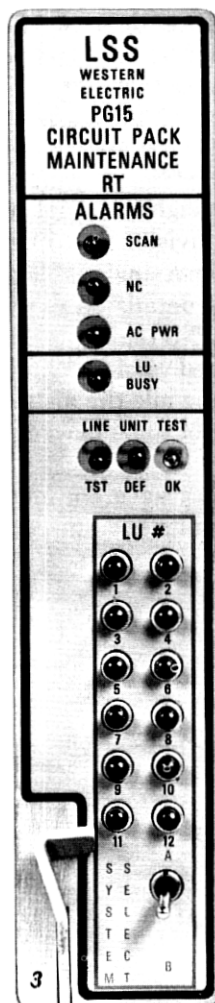
Fig. 6—LSS RT maintenance unit.
